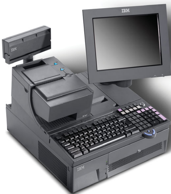
SurePOS 700 Modello 784 con display SurePoint da 15", stampante a doppia stazione SureMark, tastiera ANPOS con dispositivo di puntamento, display per il cliente 2X20" e vassoio di integrazione
